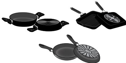
For å sikre optimal effektivitet, må du alltid benytte kjeler og panner med en flat bunn som fordeler varmen jevnt ut over. dersom bunnen er ujevn, vil dette ha innvirkning på effekt og evnen til å lede varmen.
