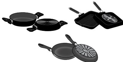
Brug altid gryder og pander med en flad bund, som fordeler varmen ensartet, for at sikre optimal effektivitet. Hvis bunden er ujævn, påvirker dette strøm- og varmefordelingen.
