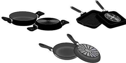
För att säkerställa optimal effektivitet ska man alltid använda kastruller och stekpannor med platt botten som fördelar värmen jämnt. Om bottnen är ojämnm inverkar det på effekten och värmefördelningen.
